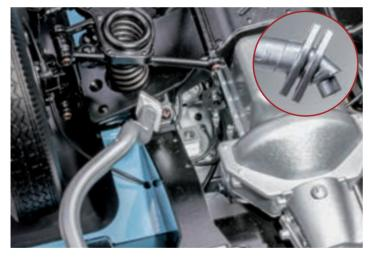
Вставьте крепежный штифт на переднем конце приемной трубы в отверстие накладки выпускной трубы, расположенной на выпускном коллекторе двигателя.
