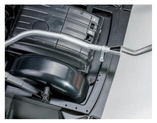
В задней части выпускной трубы совместите крепежные отверстия кронштейна с ответными отверстиями шасси модели. При помощи двух винтов 1,7×4 (АМ) зафиксируйте задний кронштейн выпускной трубы на заднем поперечном усилителе шасси.
