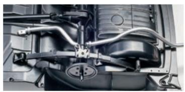
Установите выхлопную трубу глушителя на шасси модели. Для этого передний конец трубы проведите между правой полуосью заднего моста и дном модели. Плавно вращая трубу против часовой стрелки, протащите ее под мостом до середины длины трубы. Передний конец трубы должен находиться в средней части правого порога модели, а задняя часть — проходить между бензобаком и нишей запасного колеса.
