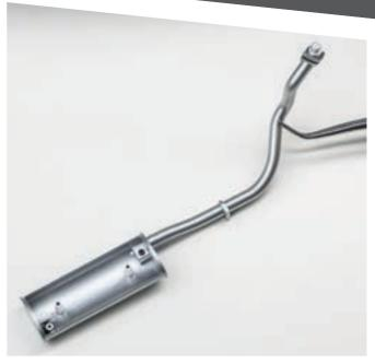
Вставьте задний конец приемной трубы в переднюю торцевую стенку глушителя. Для облегчения монтажа передняя и задняя части корпуса глушителя имеют маркировку с внутренней стороны — F (front) и R (rear) соответственно. Совместите крепежные отверстия глушителя и приемной трубы. Закрепите детали при помощи винта 1,7×4 (AP).
