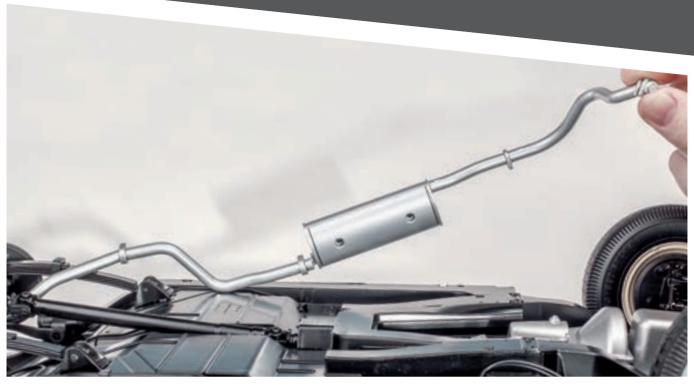
При помощи двух винтов 1,7×4 (AP) закрепите верхнюю часть глушителя на его корпусе. Обратите внимание: в процессе крепления глушителя к выхлопной трубе и соединения двух половин глушителя вся выхлопная система должна находиться на шасси. Это уточнение особенно касается задней части выхлопной трубы, которая должна располагаться между задним мостом и дном модели. В противном случае будет затруднительно устанавливать на шасси полностью собранную выхлопную систему.
